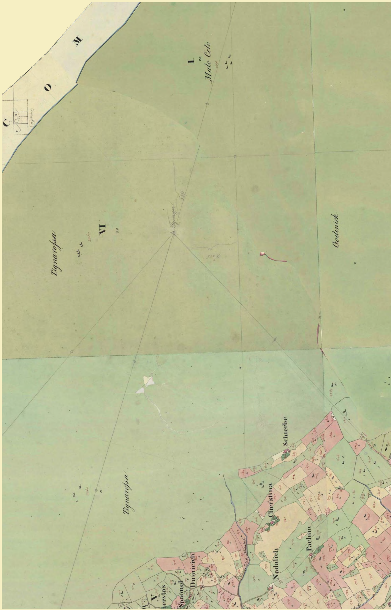
■ Részlet Rab szigetének kataszteri térképéről (Arbe és Bagnol települések térképszelvényei, 1828-ból). A térkép keleti (jobb) szélén a Tignarossa (ma: Kamenjak) csúcs, a háromszögelési pont helye ceruzával rávezetve (forrás: mapire.eu ), l. ehhez Timár Gábor és Danko Markovinović cikkét
