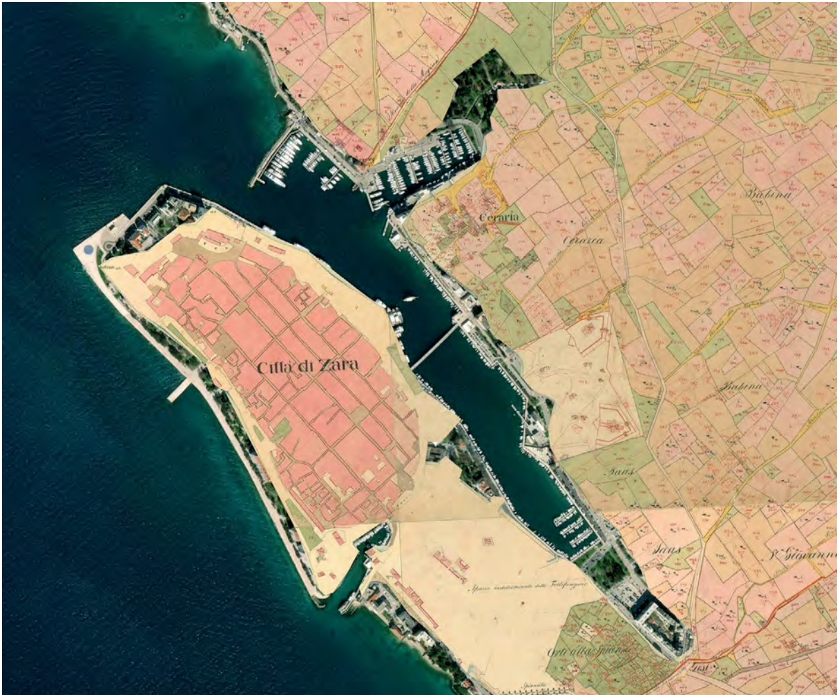
■ Zára (ma Zadar) történelmi belvárosa az 1820-as években felmért kataszteri térképen, amely a hálózati szög- és skálakorrekció alkalmazásával már pontosan illeszkedik a mai műholdfelvételhez; a partvonalakban mutakozó változások a későbbi feltöltések eredményei (MAPIRE és Open World Imagery)
