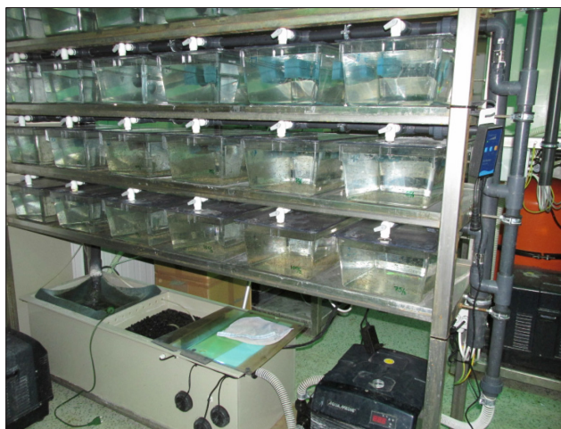
1. ábra: Recirkulációs halnevelő egység. Figure 1. Closed recirculating system with rearing tanks with a volume of 12 L.
