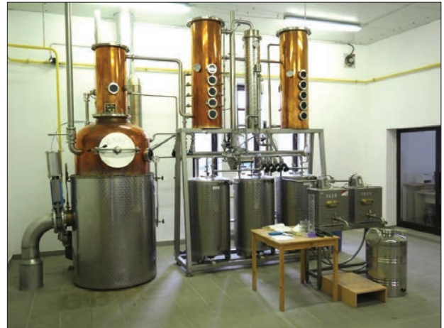
Figure 4: Rectification column distillation apparatus - Tiszta Gyümölcs Kft., Bózsva
