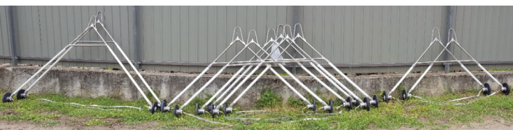
4. ábra. A háromszög alakú fenékháló-keret különböző méretű változatai (talpszélesség balról jobbra: 190, 160, 130 cm)
