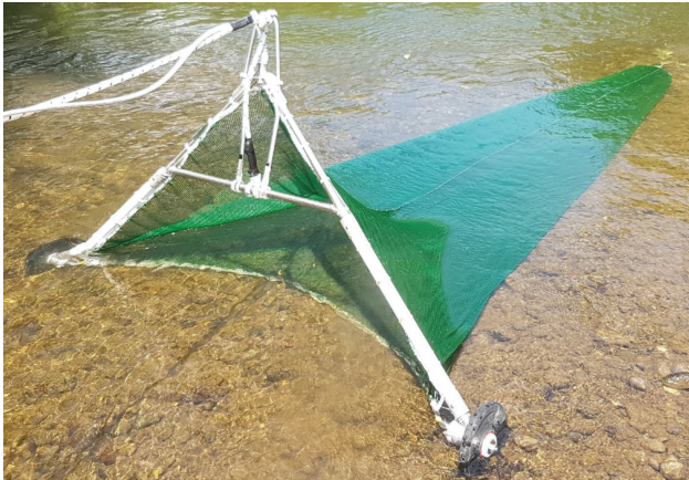
3. ábra. Az elektromos fenékháló (E-kece) végleges formája (bemutató kép, nem használat közben készült)
